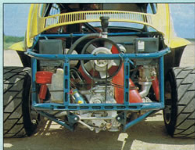
Wirkungsvoll geschützt: 200 PS-Triebwerk im Heck
