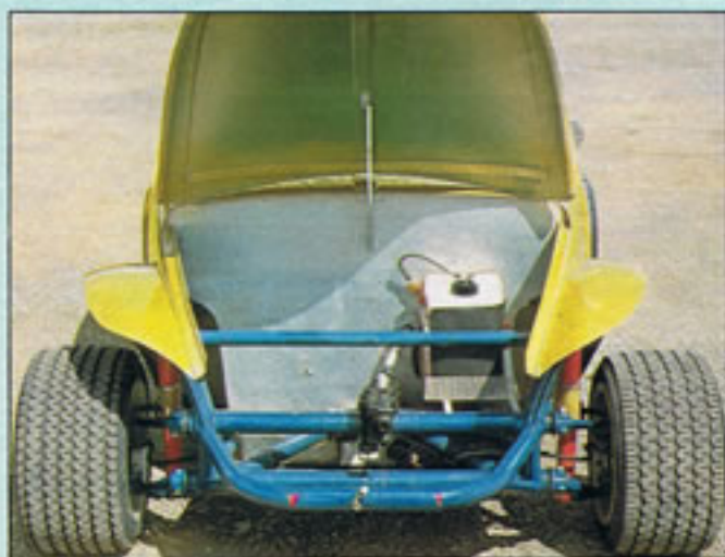
In den Rahmen integriert: Kurbellenker-Achse
